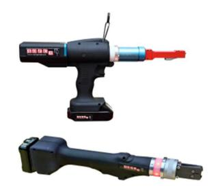
I sistemi Bluetooth per fascette permettono la oggettivazione ed il controllo della chiusura delle fascette VISA® e CLIC prodotti dalla CAILLAU. I sistemi sono in grado di verificare il corretto serraggio, contare il numero delle fascette che compongono il ciclo di assemblaggio, eseguire il trasferimento dei dati verso un sistema di archiviazione basato sull'utilizzo di PLC, PC, RETE ETHERNET
